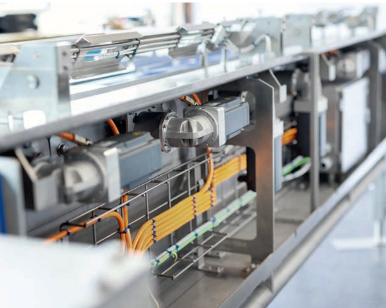
► Insgesamt sind in der Schlauchbeutelmaschine mehr als ein Dutzend CPK-Winkelgetriebe verbaut.
