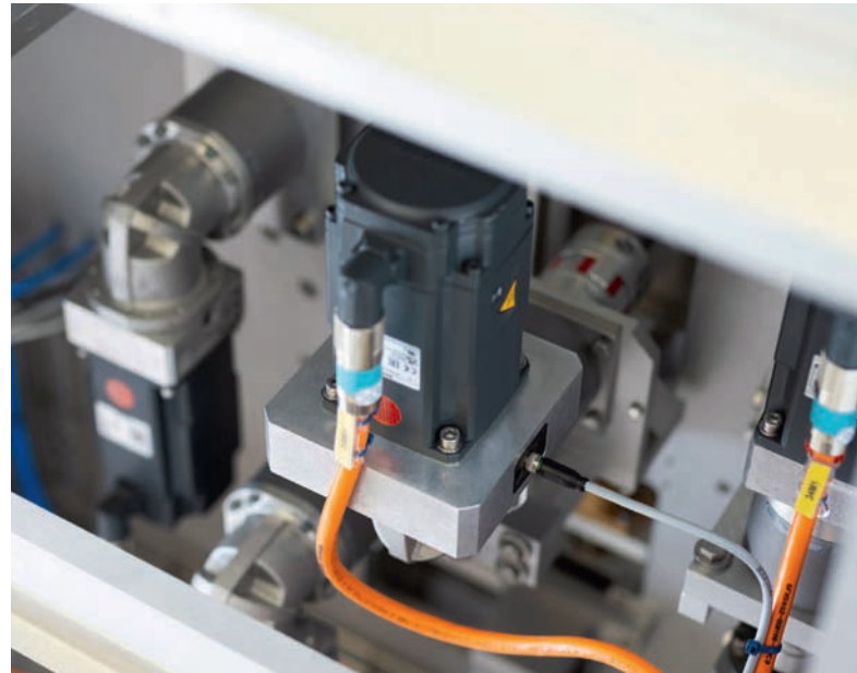
► Das Cynapse-Modul im Antrieb des Schneidmessers erfasst neben Temperaturwerten auch Vibrationen sowie Beschleunigungswerte.
