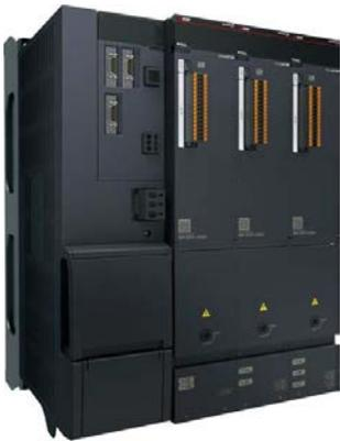
Der MR-J5D von Mitsubishi Electric bietet Anwendern die Möglichkeit, die Bremsenergie der Anwendung in nutzbare Energie umzuwandeln. Das Servo-System arbeitet mit einer Zwischenkreislösung und einer Rückspeiseeinheit. Anstatt die Bremsenergie in Hitze zu wandeln, kann diese effektiv für andere Motoren genutzt oder in die Stromversorgung zurückgeführt werden. Das spart Kosten und ist gut für den ökologischen Fußabdruck.
