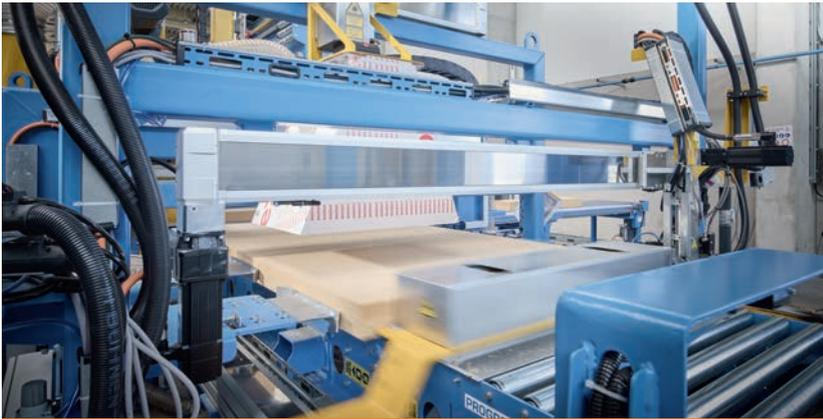
► Insgesamt 13 Lineartische und Linearmodule sowie über 60 Profilschienenführungen von Hiwin kommen im I-System der Ebawe zur vollautomatischen Verarbeitung von Dämmmaterial zum Einsatz.
