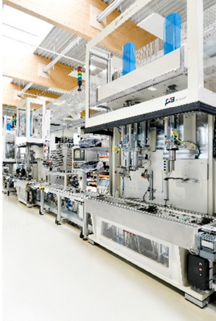
Bild 7: Die Datenauswertung mit piaOptimum an einer Pressenstation ergab eine zu hohe Solltaktzeit, die dank des Austauschs eines Werkzeugs optimiert werden konnte.
