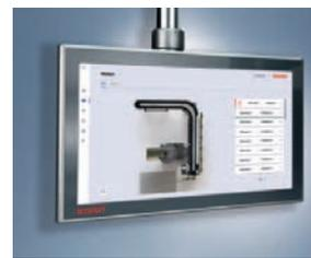
komplett neue Maschinendesigns und wird kontinuierlich weiterentwickelt: Jüngstes Beispiel ist das XTS HMI Control, das aus der bestehenden Applikation heraus mit nur einem Mausklick erstellt werden kann. Es ist automatisch mit allen notwendigen Parametern der kundenseitigen Anwendung verbunden und kann direkt die aktuellen Positionen aller Mover innerhalb des Systems anzeigen. Weitere Neuheiten, z. B. bei der Mover-Funktionalität, sind auf der Messe zu sehen.
