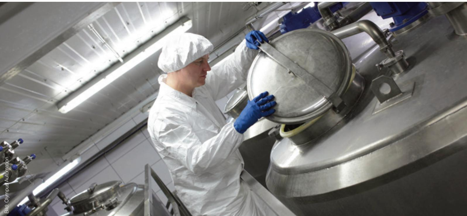
Bild 1 | Bei der Integration der PDX-Reactor-Technik kamen diverse Komponenten von Mitsubishi Electric zum Einsatz. Das Ergebnis ist eine 1.200kg schwere Anlage, in der die Soße in einem einstufigen Verfahren produziert wird.
