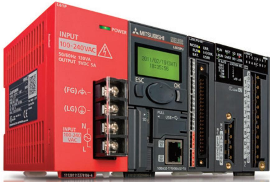
Bild 2 | Jede SPS CPU der MELSEC L Serie verfügt über 24 I/Os, einen Zwei-Kanal-Hochgeschwindigkeitszähler, eine Zwei-Achs-Positionierung sowie Pulse-Catch- und Interrupt-Funktionen. Zu den eingebauten Optionen gehört ein Ethernet-Port als Schnittstelle zu den höheren Ebenen.
