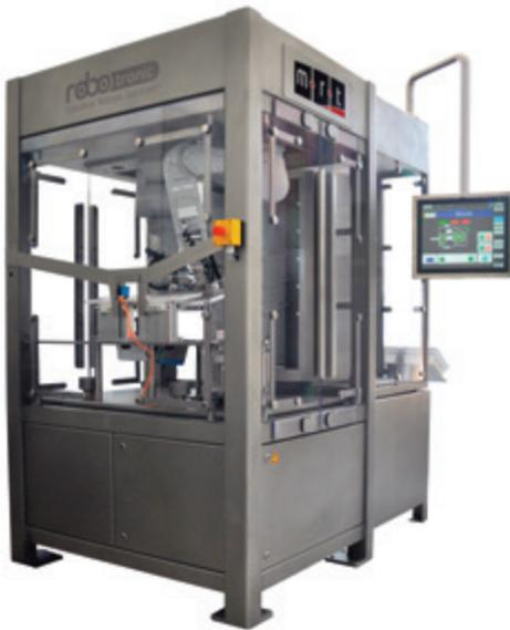
**Bild 2** | Robotronic arbeitet mit einer selbst entwickelten, modular aufgebauten Roboterzelle, in der Roboter von Mitsubishi Electric zum Einsatz kommen.
