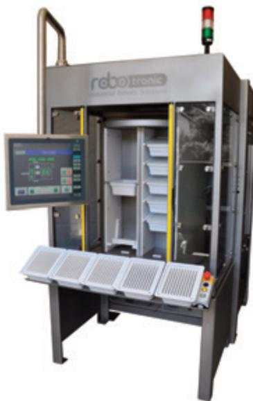
**Bild 3** | Statt eines langen Förderbandes zur Zuführung der Tubs hat Robotronic einen Drehturm entwickelt, der wie die Roboterzelle auf einem platzsparenden MRT-Modul basiert.
