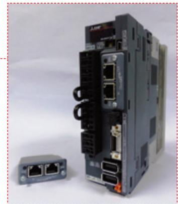
Der neue Servoregler MR-J4-TM ermöglicht erstmals die Anbindung der Mitsubishi-Electric-Servotechnik an offene Netzwerke.
