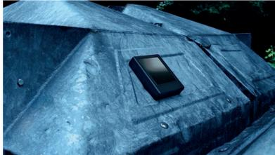
der Kreislaufwirtschaft: Die Z-Node verfügt über ein Accelerometer das mittels Micro-Energy Harvesting autark mit Strom versorgt wird und so > 10 Jahre wartungsfrei die Vibrationen am Container misst.
