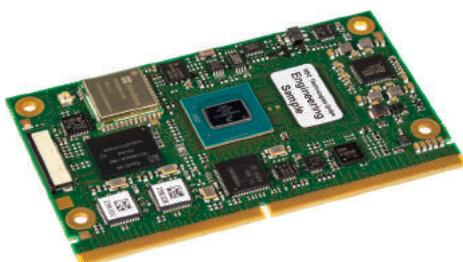
Avnet Integrated kündigt die Smarc- 2.1-Modulfamilie MSC SM2S- IMX8Plus an, die einen neuen i.MX- 8M-Plus-Applikationsprozessor von NXP Semiconductor integriert. Die skalierbare Modulfamilie zeichnet sich durch eine hohe Rechenleistung bei ef- fizientem Energieverbrauch aus, der je
