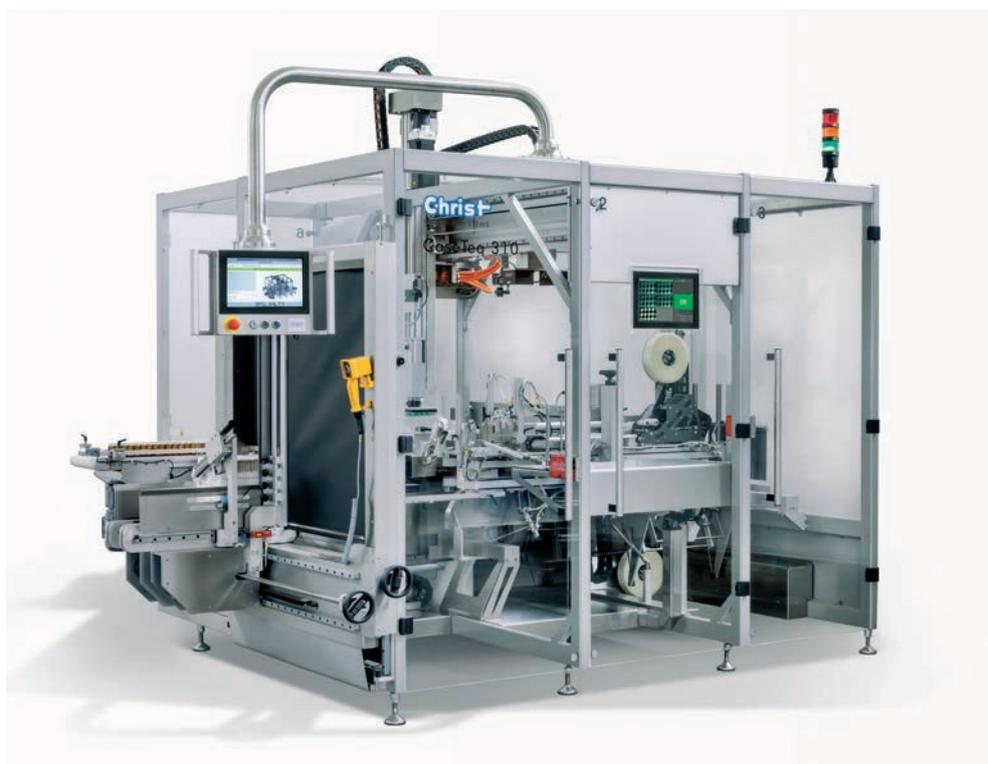
**Bild 1** | Der vollautomatische Horizontal-Casepacker CaseTeq von Christ ist eine vollautomatische Maschine zum Aufrichten, Beladen und Verschließen von vorgeklebten Versandkartons. Zukünftig übernehmen dort Kameras von B&R diverse Prüfaufgaben.
