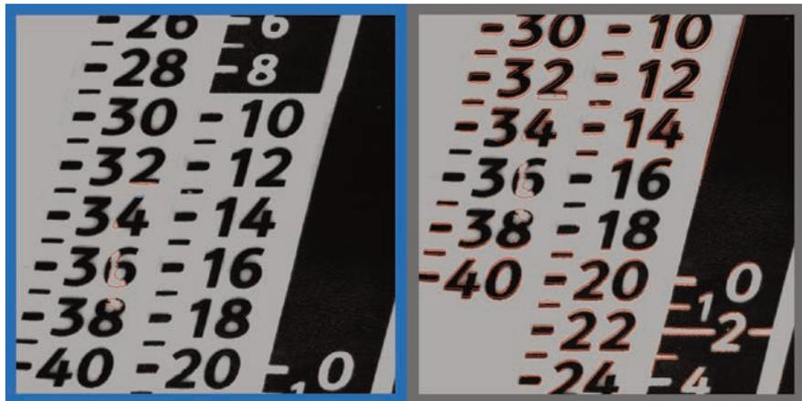
Bild 2 | Während echte Zeichenfehler (l.) erkannt werden müssen, darf die Software die Ziehharmonika-Verzerrungen des Runddrucks (r.) parametergesteuert tolerieren.
