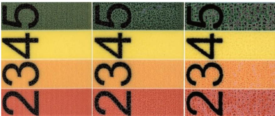
Bild 3 | Während kleinere Pigmentstörungen innerhalb der Farbflächen bis zu einem bestimmten Grad toleriert werden dürfen, sind sie ab einer definierten Schwelle (r.) ein Ausschusskriterium.
