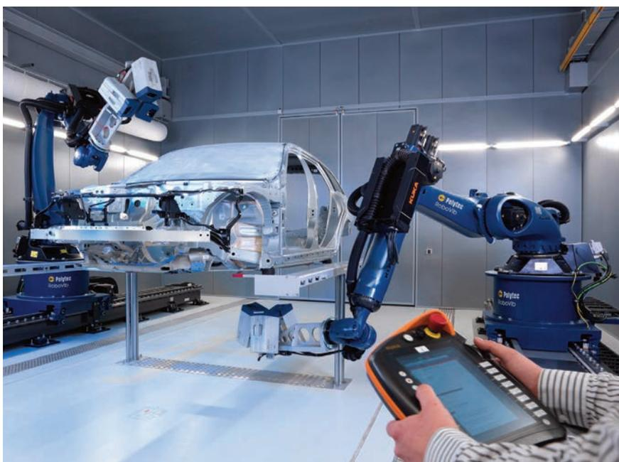
Während der 3D-Scan mit optischen Sensoren die vollständigen 3D-Daten von statischen Bauteilen erfasst und Abweichungen zwischen Ist- und Sollwerten visualisiert, wird das mechanische Schwingungsverhalten des Messobjektes berührungslos mittels Vibrometrie ermittelt. Um 3D-Scan und Vibrometrie synergetisch nutzen zu können, wurden die Verfahren beider Firmen zu einem sich ergänzenden Prozess zusammengeführt, der auf der gleichen Offline-Teaching-Software für die Roboterführung beruht.
