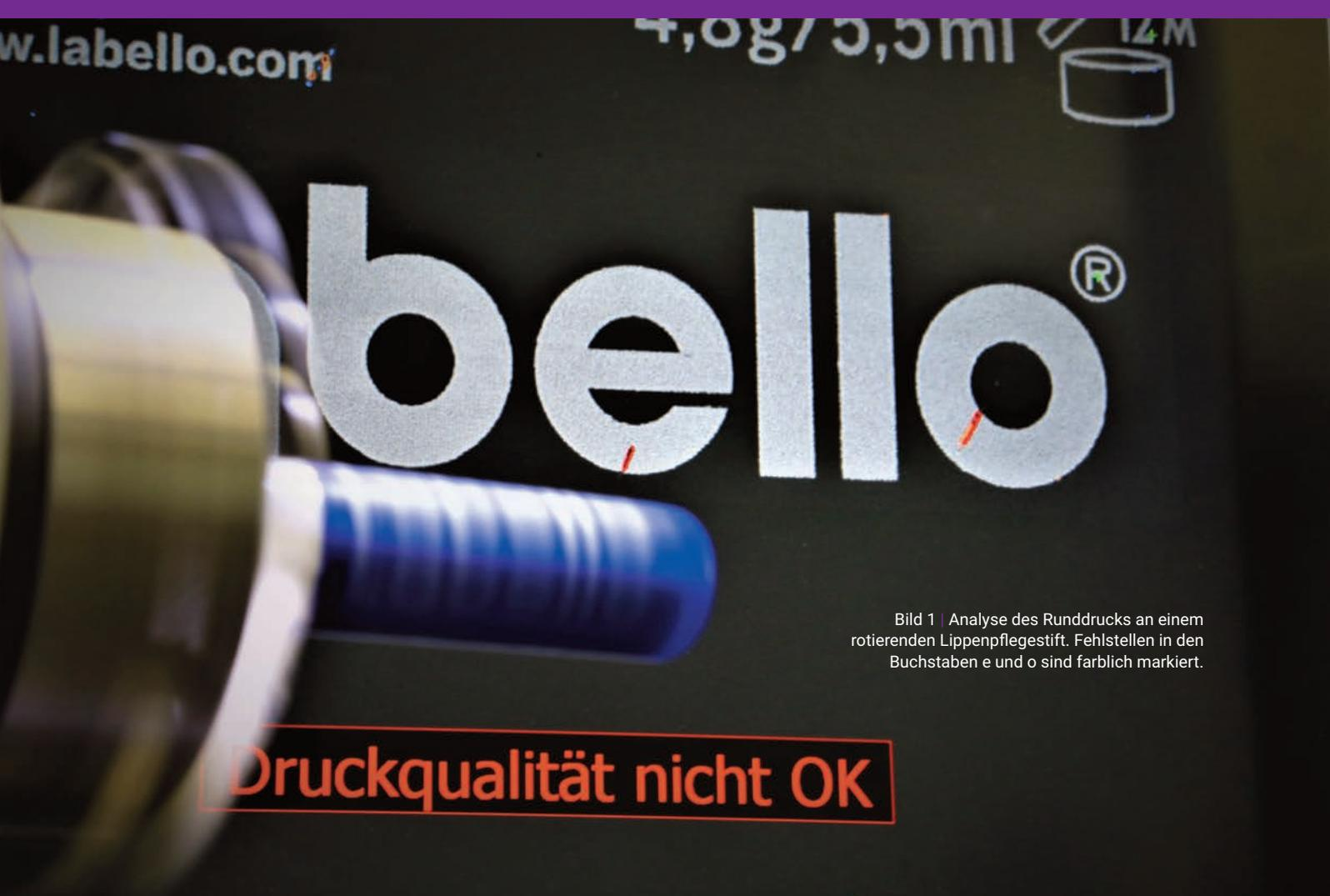
Bild 1 | Analyse des Runddrucks an einem rotierenden Lippenpflegestift. Fehlstellen in den Buchstaben e und o sind farblich markiert.
