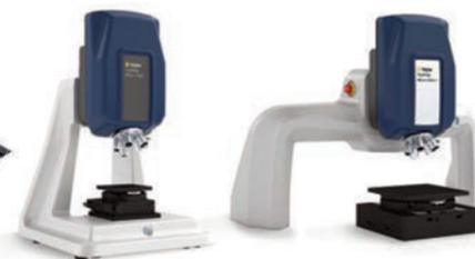
die Probenhöhe kann bis auf 370mm gemessen werden und der Messkopf ist auch separat direkt in der Fertigungslinie integrierbar.
