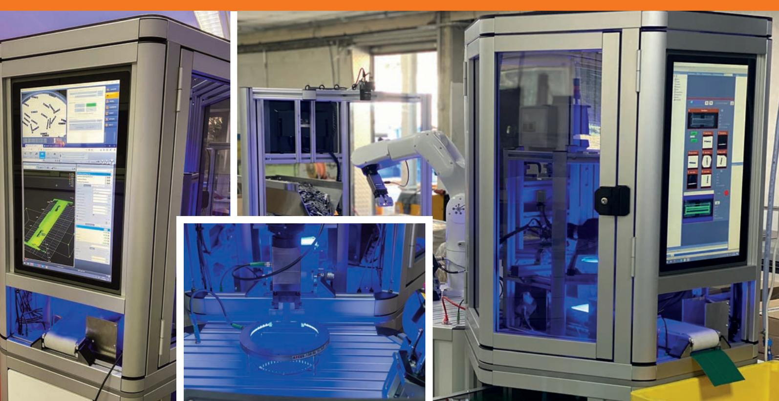
**Das modulare QBIC-System von Cretec ist eine mobile vollautomatische Arbeitsplattform auf Basis von Cobots. Unterschiedliche Module mit einem breiten Spektrum an Fähigkeiten werden in Steuerung, Kommunikation und Auswertung zu einem autonomen System verschmolzen.**
