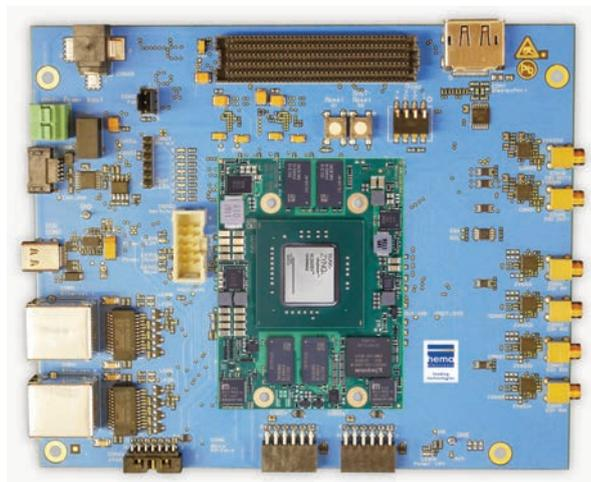
Bild 2 | Evaluation Board für Embedded Vision
