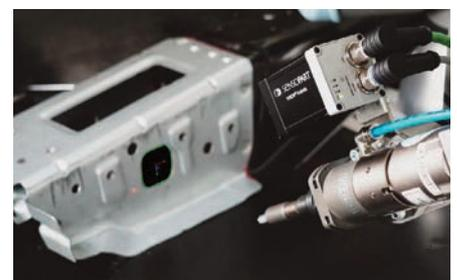
Dank des erweiterten Funktionsumfangs lassen sich gängige 2D-Anwendungen mit geringem Aufwand in der Robotersteuerung lösen. Ein zusätzlicher 3D-Detektor ermöglicht darüber hinaus eine Lageerfassung von Objekten in 3D-Koordinaten. Alle neuen Funktionen sind unabhängig vom eingesetzten Robotersystem.
