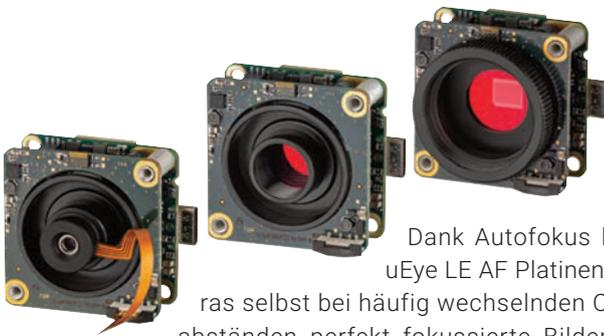
Dank Autofokus liefern uEye LE AF Platinenkameras selbst bei häufig wechselnden Objekt-abständen perfekt fokussierte Bilder. Nun sind weitere Kameravarianten mit 2,1 und 3,1MP Sony-Sensoren erhältlich. Alle Kameras (36x36x20mm) verfügen über eine USB3.1-Gen-1-Schnittstelle, USB Power Delivery und ermöglichen die Verwendung und Steuerung von Flüssiglinsenobjektiven. IDS bietet außerdem erstmals Modelle mit stehender USB-Type-C-Ausrichtung an.
