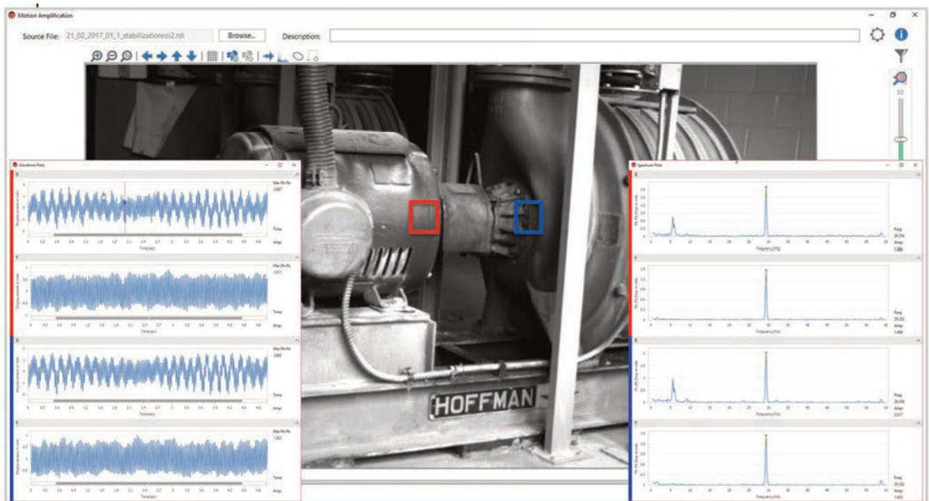
Bild 1 | Das Kamerasystem Iris M führt Millionen von Messungen im Bruchteil einer Sekunde durch. Unzulässige Schwingungen und Bewegungen werden dabei sichtbar gemacht.
