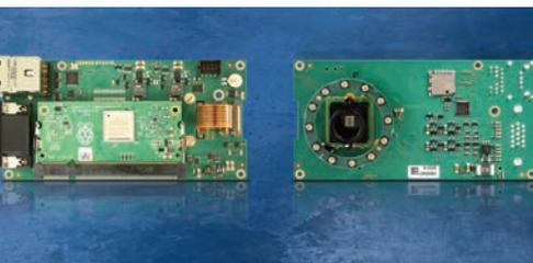
Vision-Systeme aufbauen. Kernstück ist das Compute Module Interface (CMI) Board, auf das das Raspi CM aufgesteckt wird. Das Kit enthält ein MIPI-Kameramodul (inkl. Softwaretreiber), ein FPC-VC-MIPI-Kabel und einen S-Mount/M12-Objektivhalter. Eine Triggerfunktionalität ist vorhanden. Standardmäßig ist das Bundle mit dem OV9281-Bildsensor von OmniVision mit einer Auflösung von 1MP, 120fps und Global Shutter ausgestattet.
