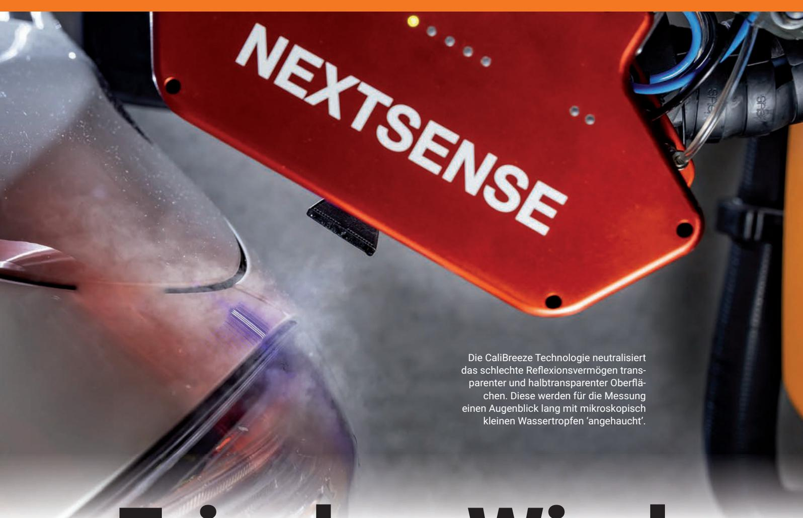
Die CaliBreeze Technologie neutralisiert das schlechte Reflexionsvermögen transparenter und halbtransparenter Oberflächen. Diese werden für die Messung einen Augenblick lang mit mikroskopisch kleinen Wassertropfen 'angehaucht'.
