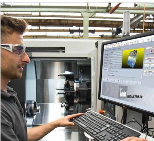
**Punktgenaue Information** – PC Info-Points mit der COSCOM FactoryDIRECTOR VM Software sorgen für die Technologiedaten-Visualisierung an den Informations-Hotspots direkt an den Maschinen. Mit der digitalen Visualisierung aller fertigungsrelevanter Informationen kommt Stromag seinem strategischen Ziel der papierlosen Fertigung Schritt für Schritt näher.
