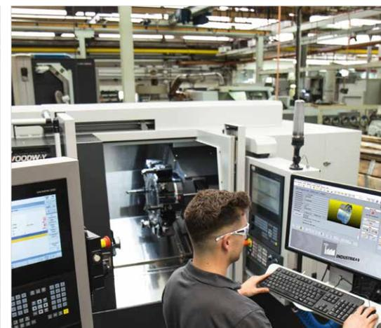
**Vernetzter Shopfloor** – Die Maschinenanbindung an den FactoryDIRECTOR VM findet über DNC statt. Rund 25 CNC-Maschinen sind aktuell über COSCOM WLAN DNC vernetzt.
