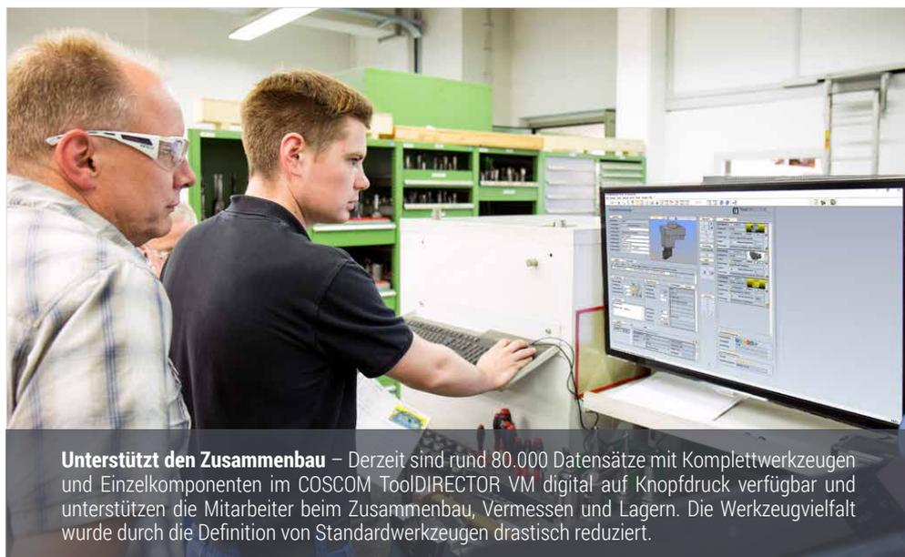
**Unterstützt den Zusammenbau** – Derzeit sind rund 80.000 Datensätze mit Komplettwerkzeugen und Einzelkomponenten im COSCOM ToolDIRECTOR VM digital auf Knopfdruck verfügbar und unterstützen die Mitarbeiter beim Zusammenbau, Vermessen und Lagern. Die Werkzeugvielfalt wurde durch die Definition von Standardwerkzeugen drastisch reduziert.
