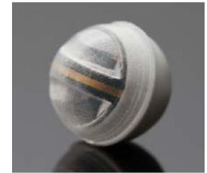
Ziel dieser Innovation war die Entwicklung von drahtlosen, autarken, ortsunabhängigen, minimal invasiven Mikromesskügelchen (7,8 mm Durchmesser) zur Erfassung von T, pH- und Gelöstsauerstoff in wässrigen Prozessen (z. B. Bioreaktoren).
