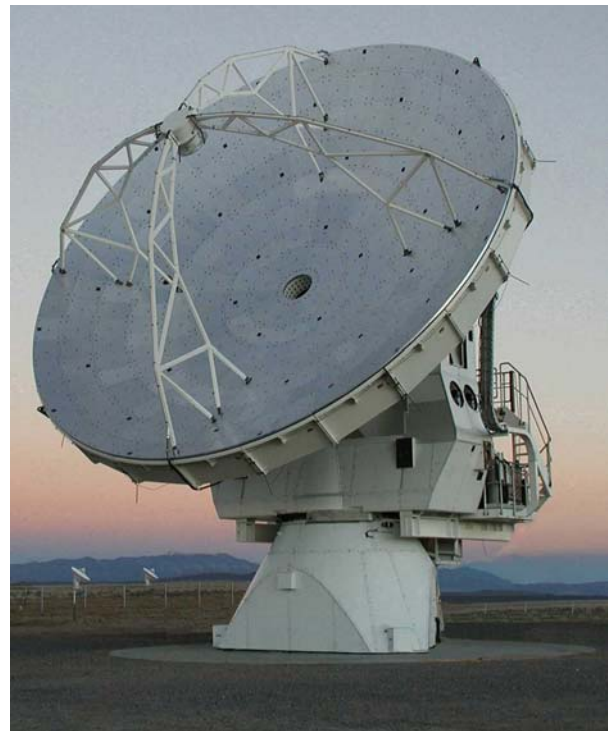
Abb. 1 Beim ALMA-Projekt in der Atacama-Wüste in Chile werden bis zu 64 Antennen zu einem riesigen Radioteleskop zusammengefasst. Hexapod-Systeme von PI positionieren die Sekundärreflektoren der Teleskope – Die auch gegen extreme Umgebungsbedingungen unempfindlichen Systeme der Serie M-850K können Massen bis zu 75 kg bewegen (Vertex Antennentechnik GmbH)
