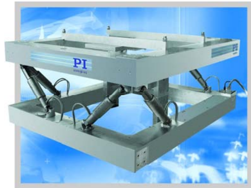
Abb. 6 Mit Abmessungen von 100 x 84 x 40 cm und einer Belastbarkeit bis zu 200 kg ist dieses Sondermodell für alle Arten von Feinpositionieraufgaben geeignet, klassisch in der Inspektion von TV-Bildschirmen. (Physik Instrumente (PI))
