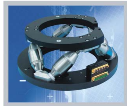
Abb. 3 Der nicht magnetische NEXLINE® Hexapod basiert auf sehr genauen Hochlast-Piezoschrittantrieben. Seine Belastbarkeit liegt bei 500 N ("umgangssprachlich" 50 kg) (Physik Instrumente (PI))
